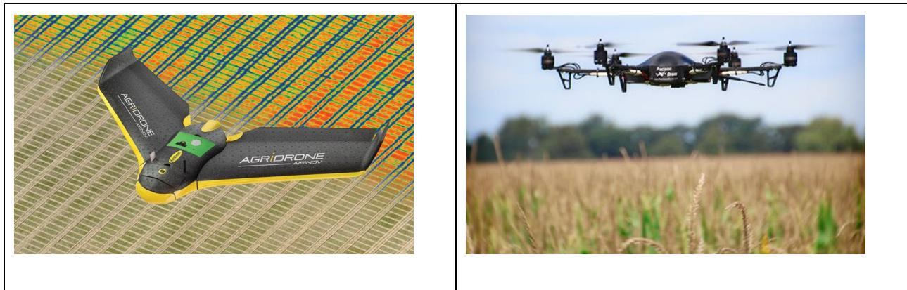
Slika 3. Tipovi dronova (zrakoplovni i višerotorski dron)
